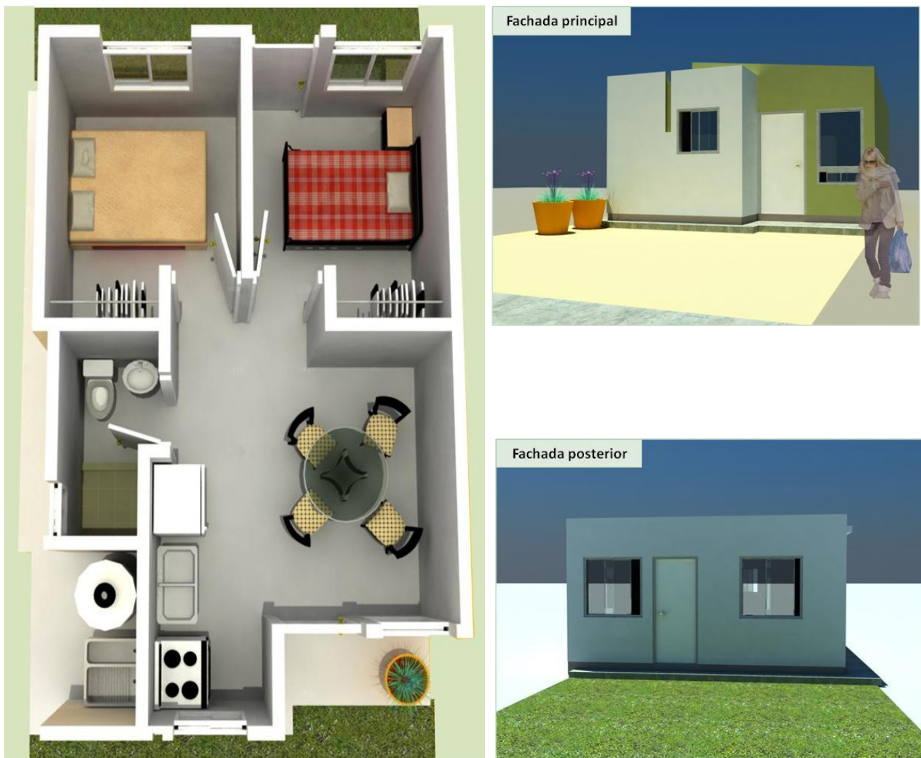
Ilustración 6. Planta arquitectónica y fachadas principales en perspectiva.
